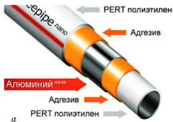
Рис. 3. Структура нанокompозитной трубы
